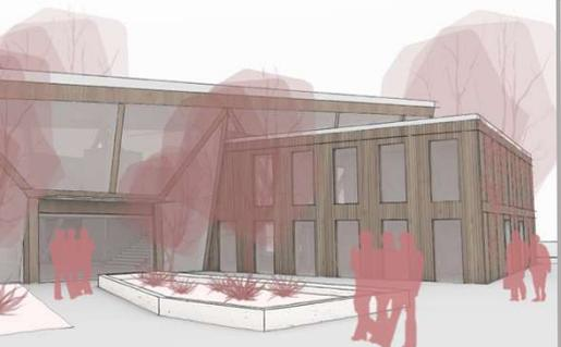
Das Gebäude gliedert sich in zwei Riegel, von denen einer im Woodrocks-Bausystem errichtet wird und der andere in Form eines vorgefertigten Holzfachwerks.
